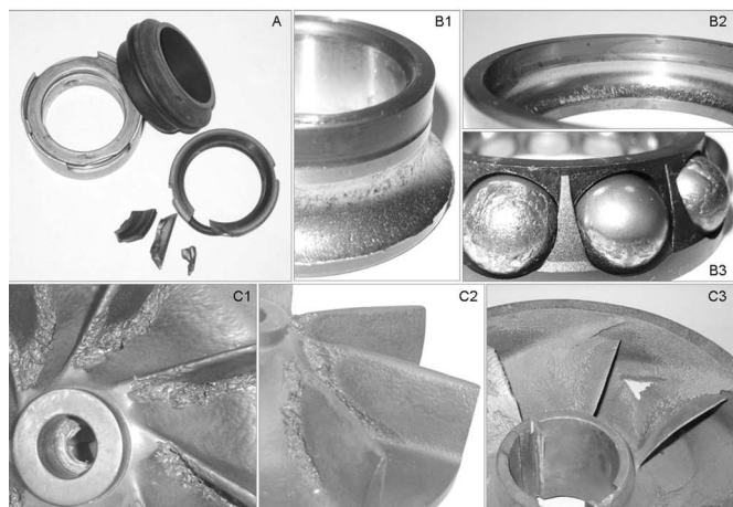
Bild 1: Ausfallkritische Pumpenbauteile: Durch Trockenlauf zerstörte GLRD (A); Innenring (B1), Außenring (B2) und Käfig mit Wälzkörpern (B3) eines defekten Wälzlagers; durch Kavitationserosion zerstörte Laufräder einer Kreiselpumpe (C1 - C3).
