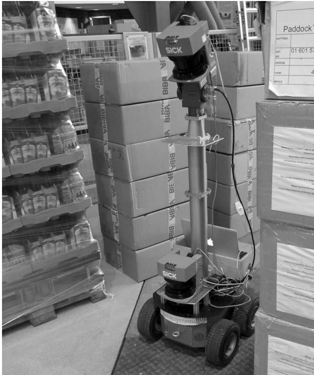
Bild 2: Der Roboter (hier noch ohne RFID-Reader und -Antenne) bei Fahrversuchen in einer nachgestellten Lagerumgebung.
