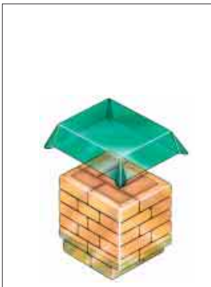
4 Auflegen der abschließenden Flachfolie
