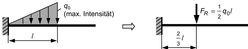
Bild 1.32 Resultierende einer Rechtecklast und einer linear veränderlichen Last (Dreiecklast)
